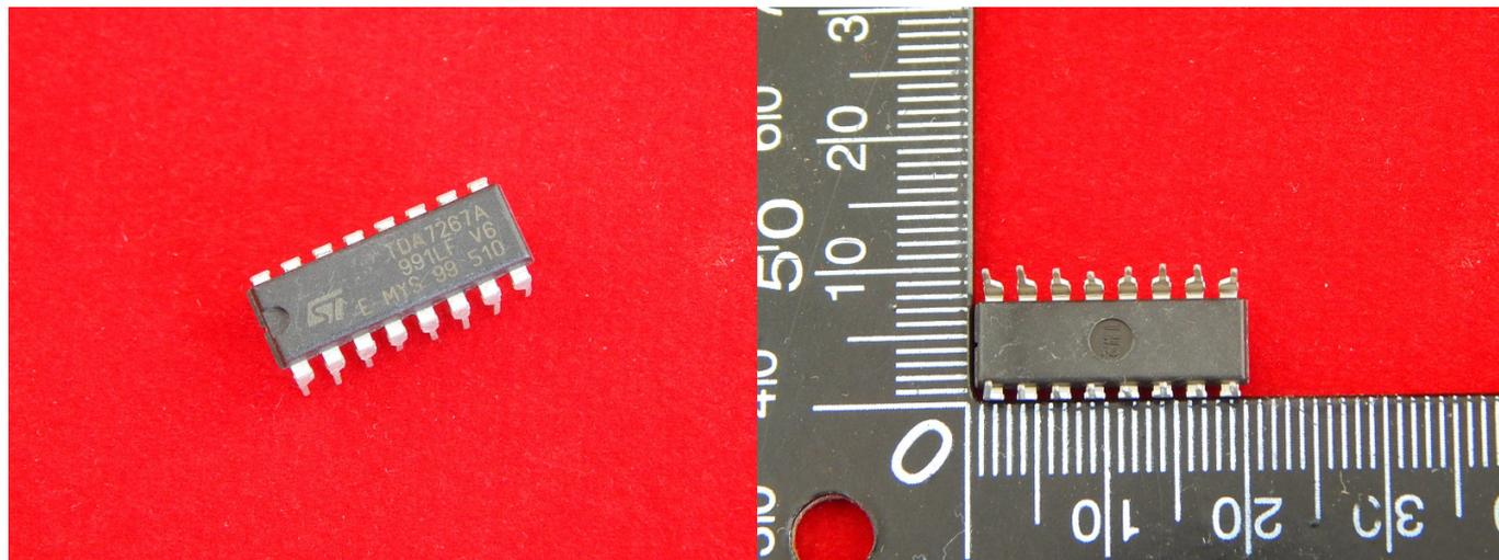
Одноканальный аудиоусилитель, специализированная ИМС для ТВ TDA7267A 3Вт, 14.5В, 8 Ом
