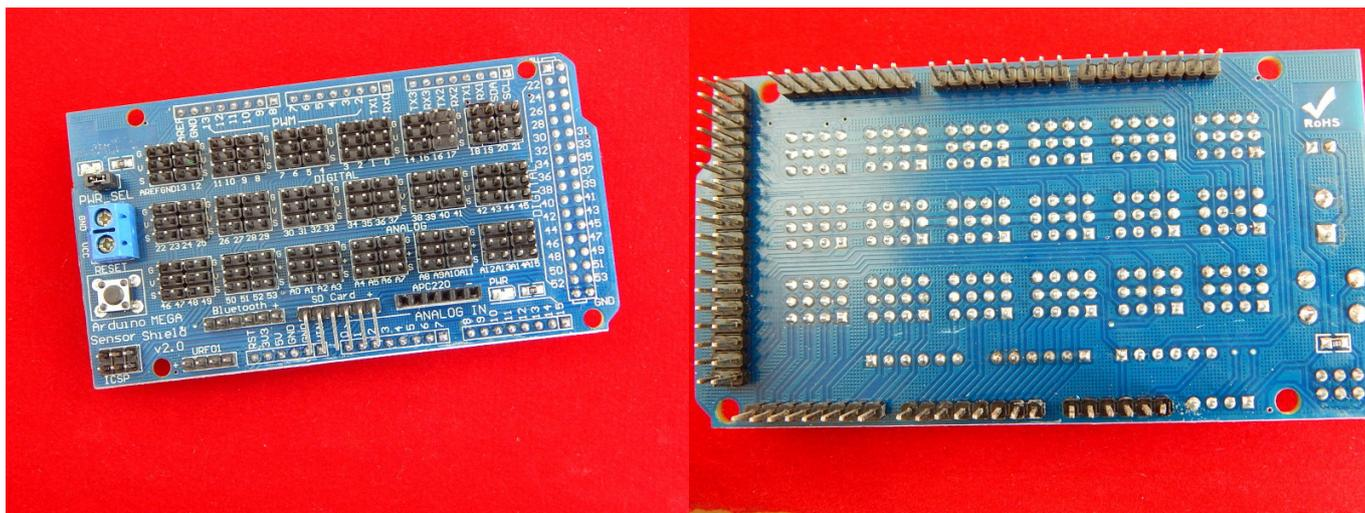
Коммутационная плата Mega Sensor Shield V2.0 предназначена для расширения функциональности контроллеров на платформе Arduino Mega.
