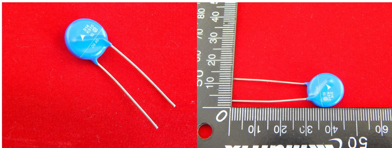
Металлоксидные дисковые варисторы SIOV представляют собой нелинейные резисторы с симметричной вольтамперной характеристикой. Варисторы обеспечивают защиту от всех видов пренапряжения и предотвращают выход электрического оборудования из строя.
