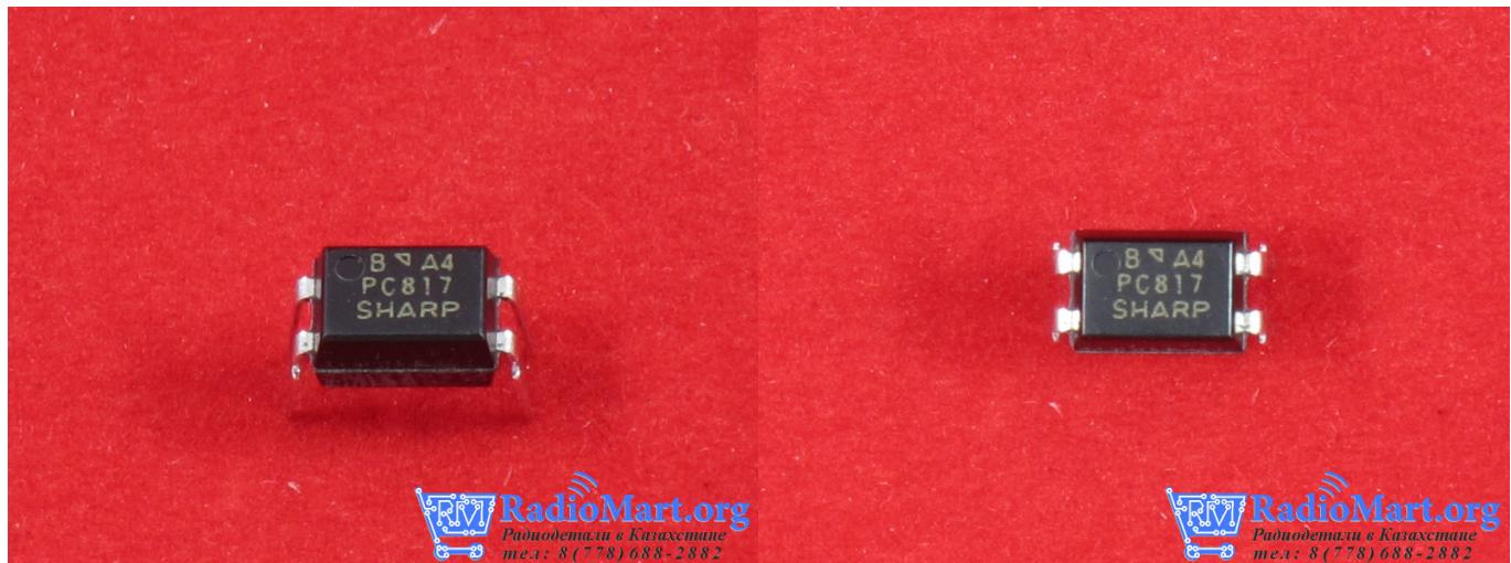
Оптопара EL817C (PC817, LTV817) состоит из светодиода и фототранзистора. Открытие фототранзистора зависит от освещенности светодиодом.
