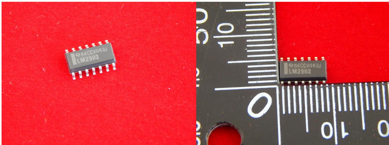
Операционный усилитель LM2902 1.3 МГц, 4 Усилителя, 0.4 В/мкс,  $\pm 1.5\text{В}$  до  $\pm 15\text{В}$ , TSSOP
