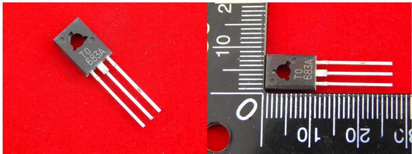
Транзистор KT683A NPN, высокочастотный, большой мощности, TO-126 (KT-27)
