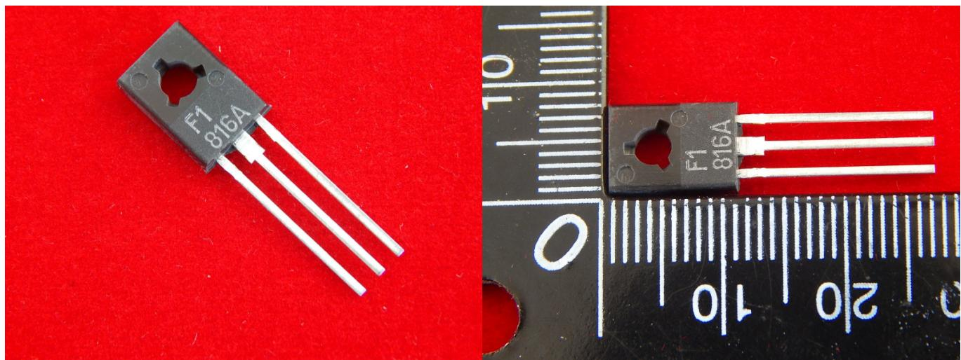
KT816A, Транзистор PNP, низкочастотный, большой мощности, ТО-126 (KT-27)
