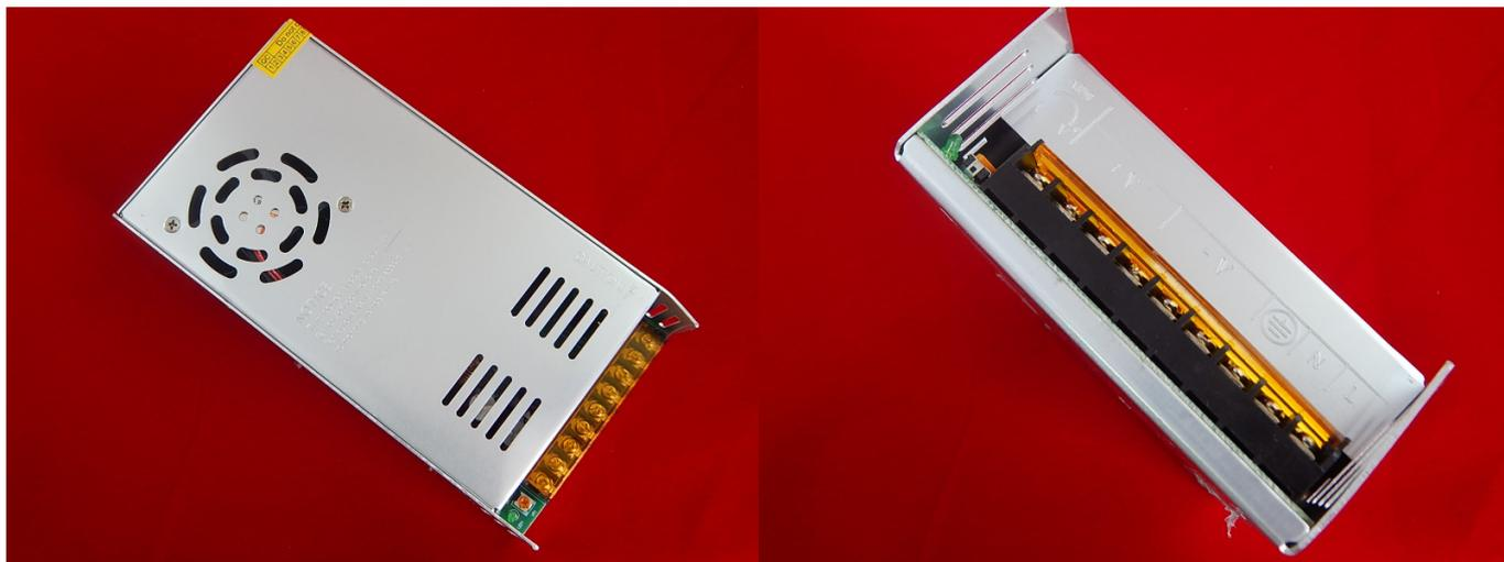
Блок питания 24В 20А 500Вт (S-500-24) - импульсный блок питания. Имеет встроенный вентилятор, который включается автоматически, при достижении критической температуры. БП защищен от короткого замыкания, перенапряжения, перегрузок и высокой температуры.
