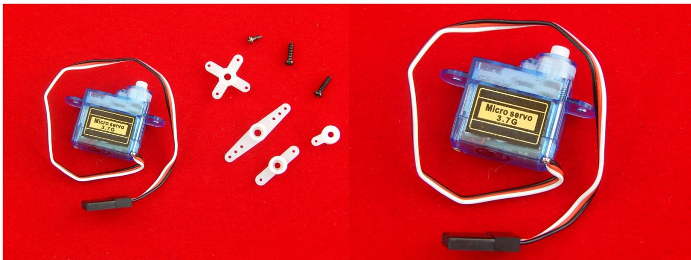
Формат «микро» полезен там, где важен размер и вес привода. В комплекте с сервоприводом идёт комплект крепежа и пластиковых качелек. Привод может быть подключен непосредственно к микроконтроллеру, без силового драйвера.
