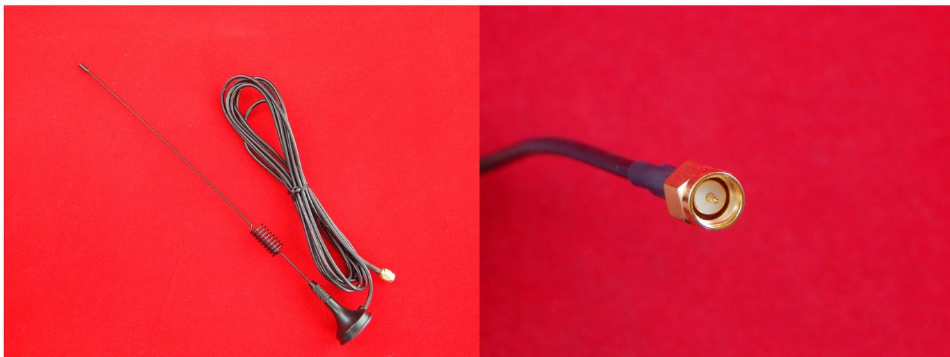
Всенаправленная GSM антенна 900/1800MHz SMA с усилением 7 dBi на магните с кабелем длиной 1.5 метра (модель GSM 174).
