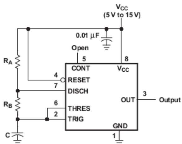
Таймер на выходе «Output» постоянно выдаёт импульсы определённой частоты и скважности. Время в состояниях логической единицы и нуля можно рассчитать по формулам:
