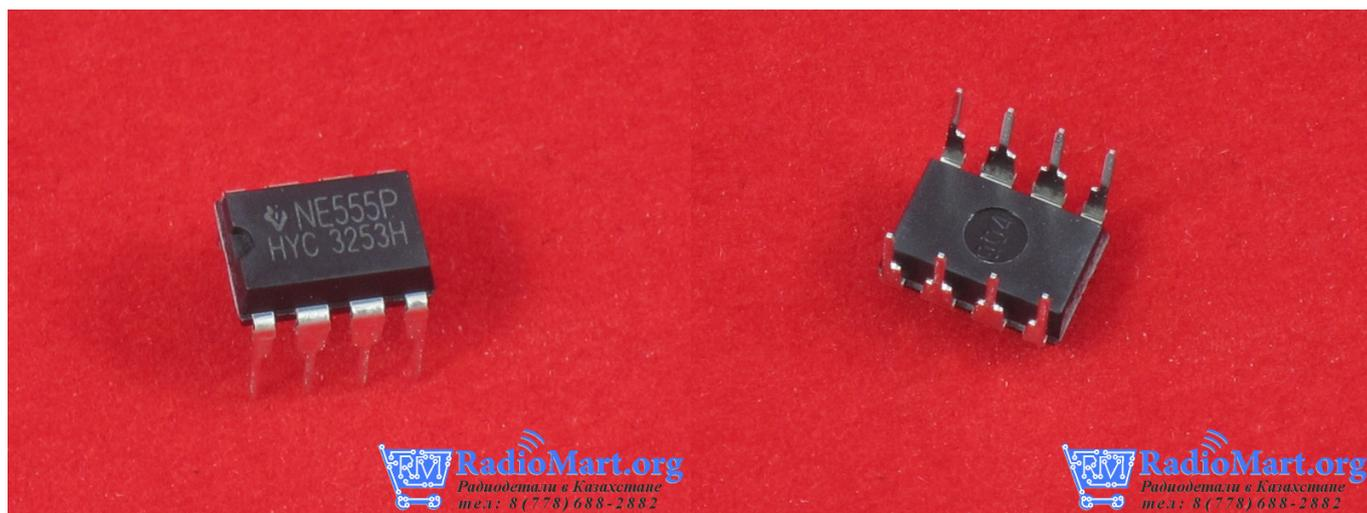
Микросхема 555 позволяет либо разово выдавать импульсы определённой длины, либо выдавать импульсы постоянно, через заданные промежутки времени. Режим работы и параметры выходного сигнала зависят от подключённой к ногам микросхемы обвязки, которая строится из конденсатора и резисторов.
