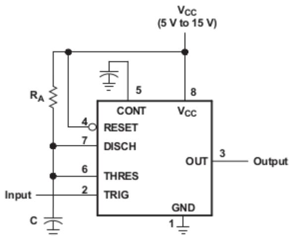
Как только на вход «Input» подаётся логический ноль, на выходе «Output» возникает импульс из логической единицы фиксированной длины, не зависящей от длительности и формы входного сигнала.
