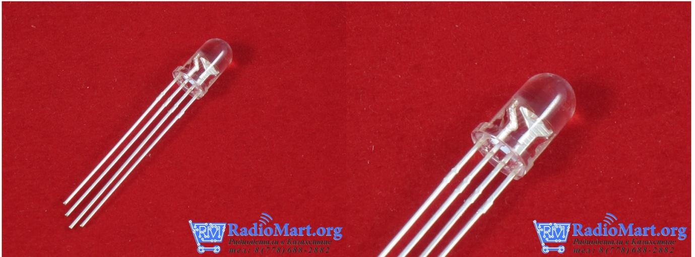
Данный светодиод позволяет получить огромное количество цветов управляя яркостью трех светодиодов (RGB) расположенных в одном корпусе.
