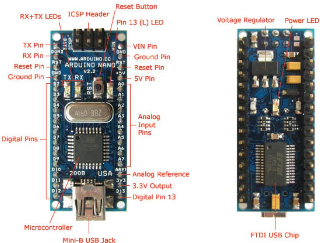
Каждый из 14 цифровых выводов Nano, используя функции [pinMode\(\)](#), [digitalWrite\(\)](#), и [digitalRead\(\)](#), может настраиваться как вход или выход. Выводы работают при напряжении 5 В. Каждый вывод имеет нагрузочный резистор (стандартно отключен) 20-50 кОм и может пропускать до 40 мА. Некоторые выводы имеют особые функции:
