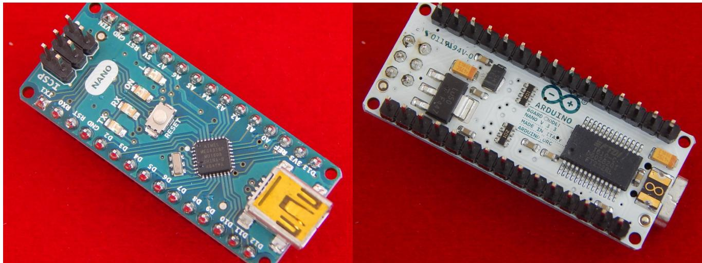
Платформа Nano, построенная на микроконтроллере ATmega328 (Arduino Nano 3.0), имеет небольшие размеры и может использоваться в лабораторных работах. Она имеет схожую с Arduino Duemilanove функциональность, однако отличается сборкой. Отличие заключается в отсутствии силового разъема постоянного тока и работе через кабель Mini-B USB.
