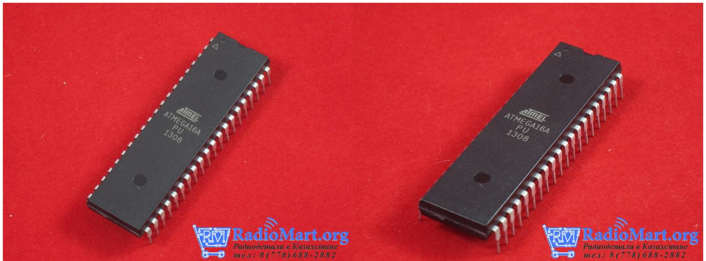
8-разрядный высокопроизводительный AVR микроконтроллер с малым энергопотреблением
