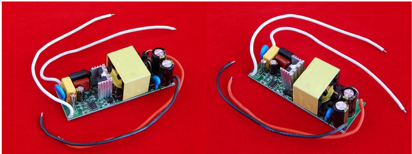
Преобразователь напряжения 220 вольт на 35 Вольт для подключения 50 Вт светодиодов
