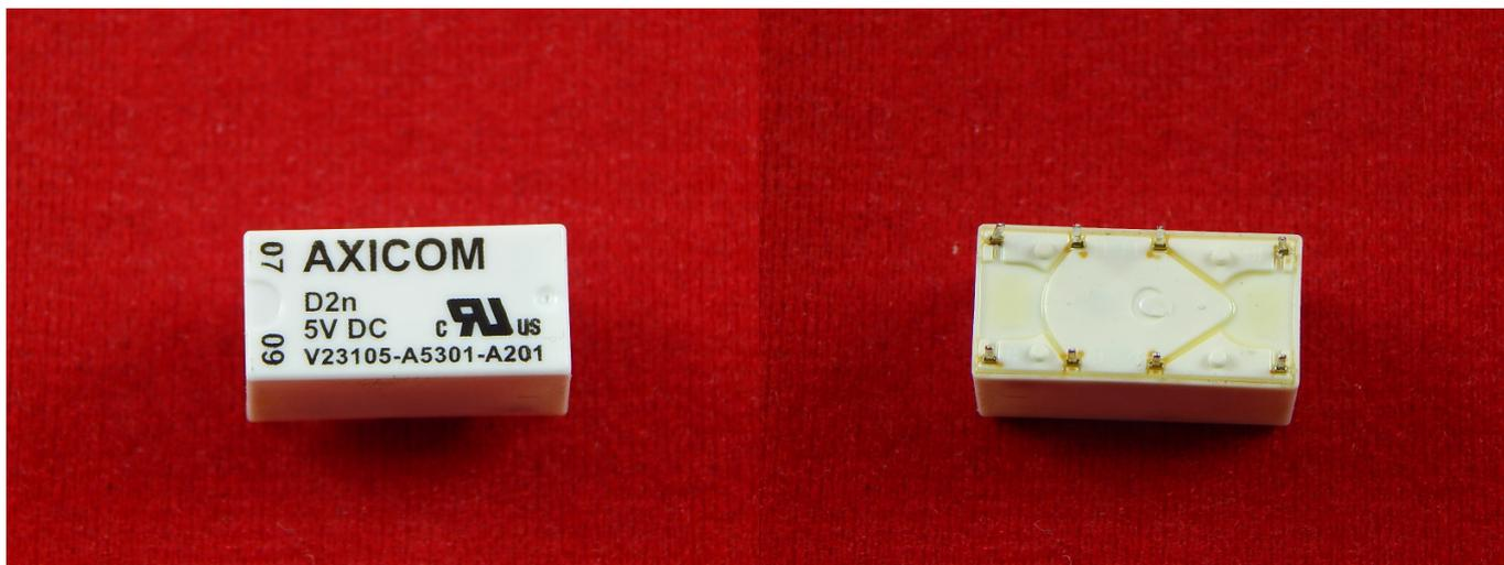
Реле на 2 переключателя, с напряжением 5В рассчитанный на нагрузку в 3А
