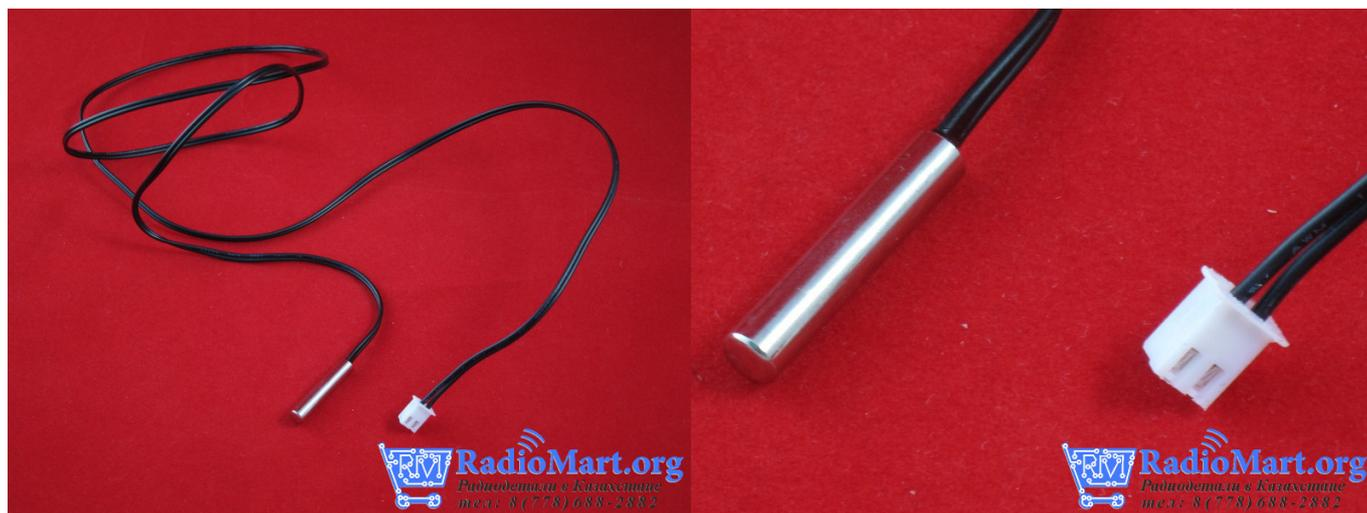
Термистор - это резистор, сопротивление которого меняется от температуры. Данный термистор измеряет температуру окружающей среды, воды и так далее с помощью Arduino АЦП (NTC 10k  $\pm$  1% 3950).
