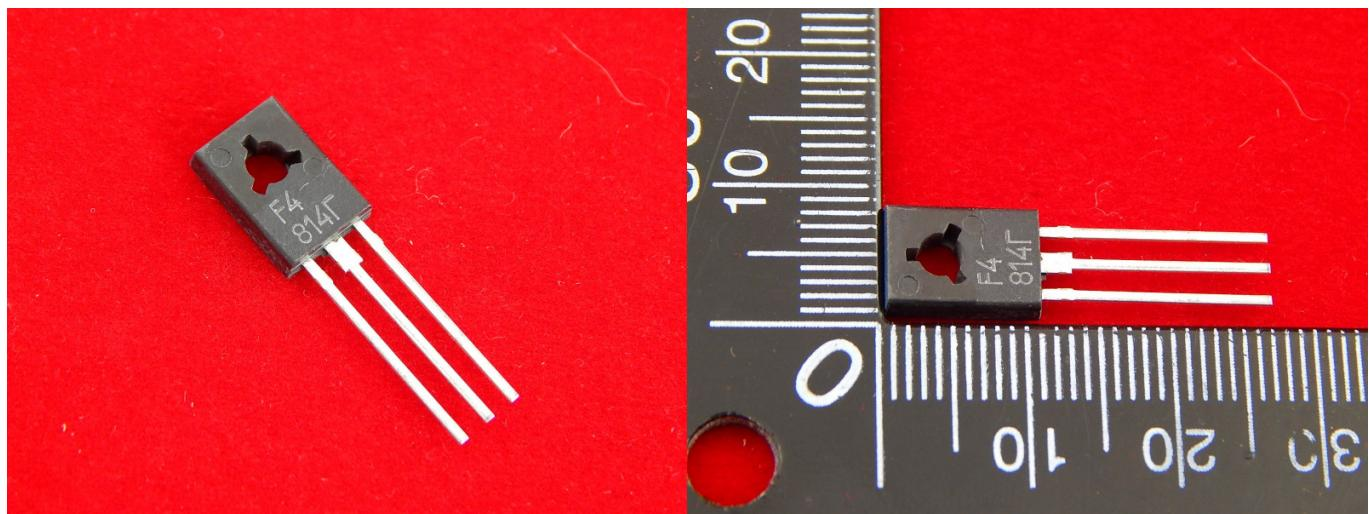
KT814Г, Транзистор PNP низкочастотный, большой мощности, TO-126 (КТ-27) (BD140)
