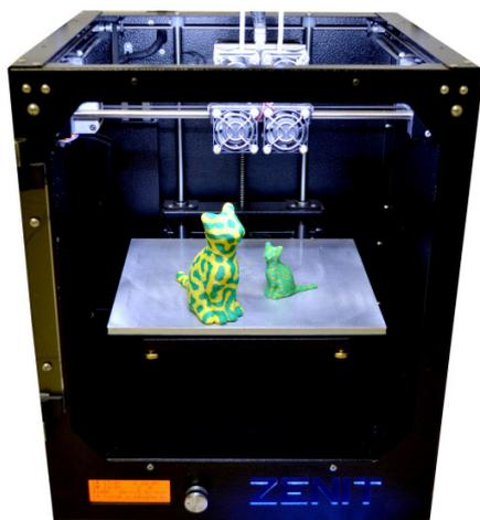
*3D принтер Zenit с двумя экструдерами позволит вам создавать сложные элементы. Наличие двух экструдеров дает возможность выращивать детали с применением растворимых поддержек PVA и HIPS.*
