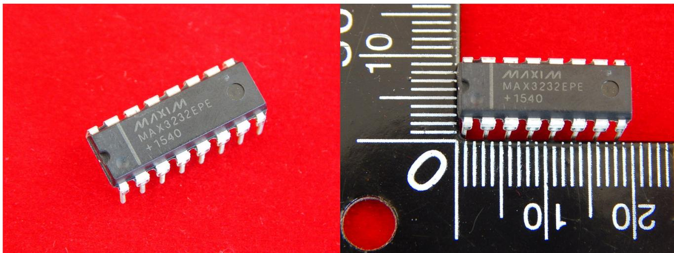
MAX3232EPE, Многоканальный драйвер/приемник RS-232, +5,5В [DIP-16]
