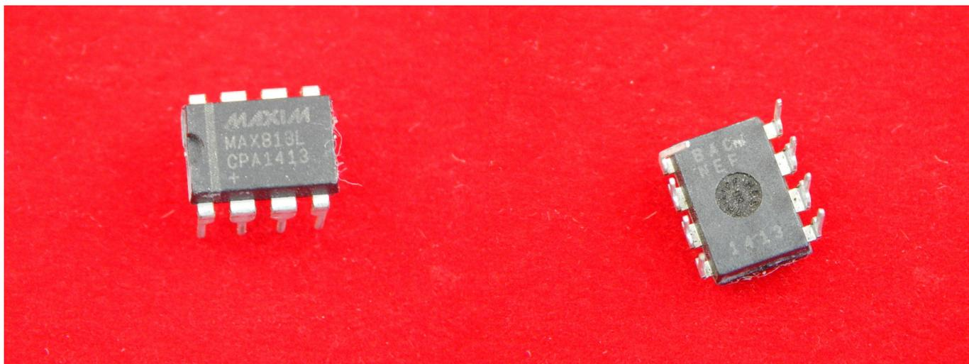
MAX813LCRA Устройства Мониторинга 1.1В-5.5В (Vin), DIP-8
