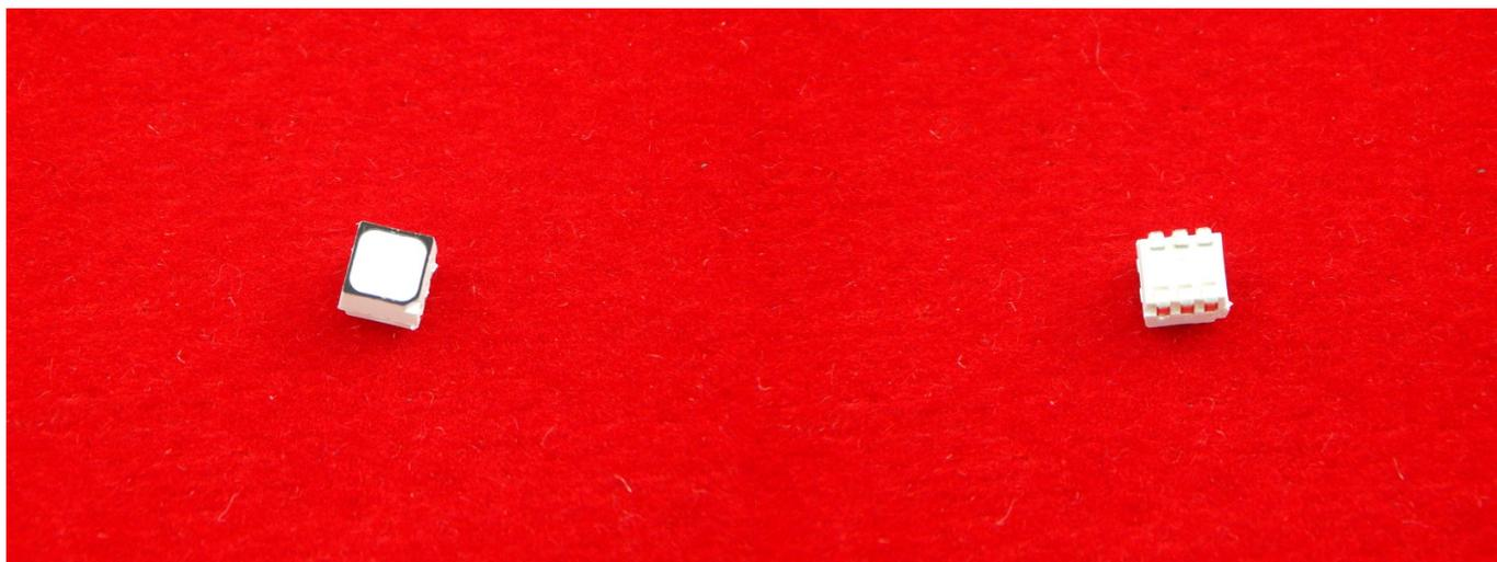
Светодиоды для поверхностного монтажа (3535 LED RGB)
