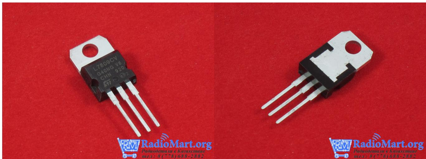
На выходе выдает ровные 9 Вольт, выдерживает хороший ток, особенно микросхемы в корпусе ТО220 при монтаже на радиатор.
