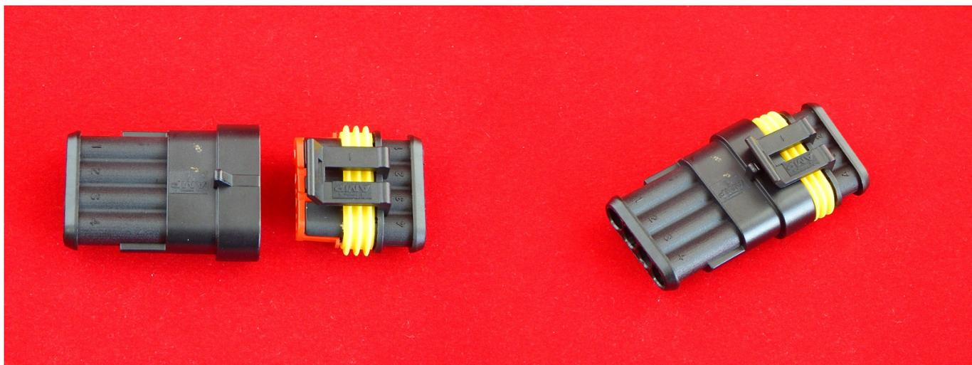
Герметичный водонепроницаемый разъем, 4-х пиновый на провод. Имеет резиновые прокладки на каждый кабель и в месте соединения. Для более плотного соединения имеется прищепка фиксатор.
