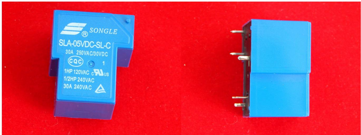
Мощное реле с управляемым питанием 5V
