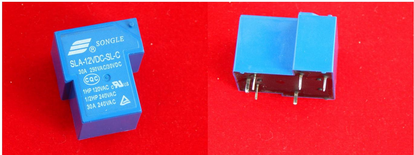
Мощное реле с управляемым питанием 12V
