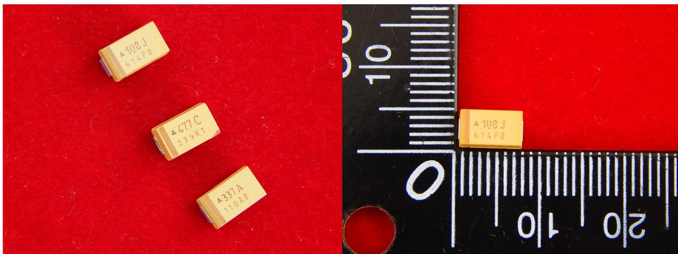
Танталовые электролитические конденсаторы - это малогабаритные конденсаторы высокой стабильности с низким током утечки, устойчивыми частотными и температурными характеристиками и длительным сроком службы.
