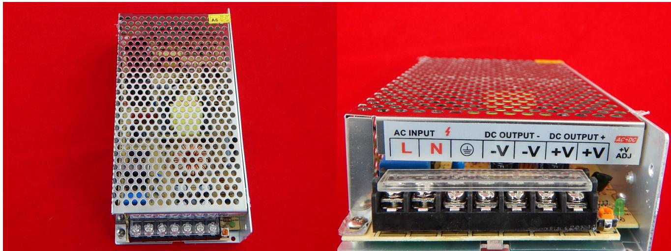
Блок питания 12В 10А 120Вт (S-120-12) - импульсный блок питания. Имеет встроенный вентилятор, который включается автоматически, при достижении критической температуры. БП защищен от короткого замыкания, перенапряжения, перегрузок и высокой температуры.
