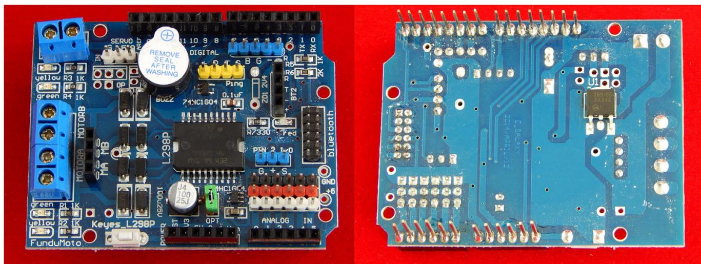
Motor Shield для ARDUINO. Драйвер двигателей для контроллеров Arduino и их аналогов, позволяет управлять скоростью и направлением вращения двух двигателей. Шилд собран на микросхеме L298P, с помощью которого можно управлять двумя двигателями постоянного тока или шаговым мотором.
