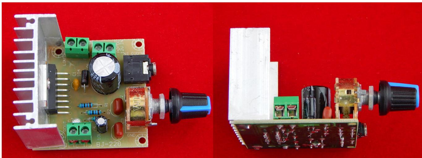
Двухканальный цифровой усилитель мощности стерео.
