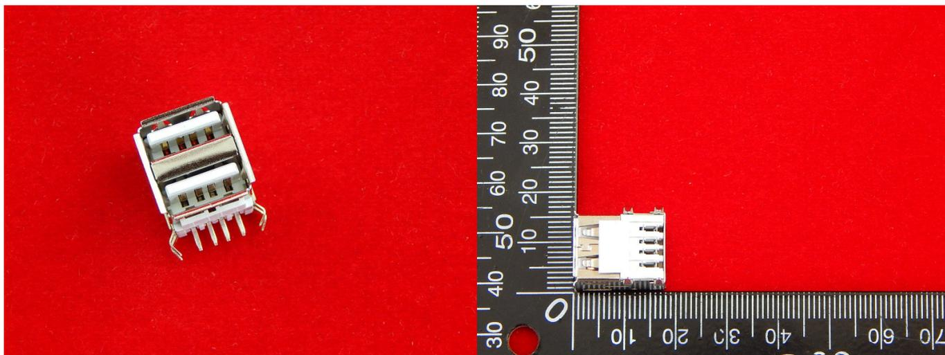
Двойной разъем гнездо на плату USB-A (металл) предназначен для подключения периферийных и портативных устройств к компьютерной технике с помощью кабелей формирующих интерфейс между USB-устройствами и программно-управляемым USB-контроллером.
