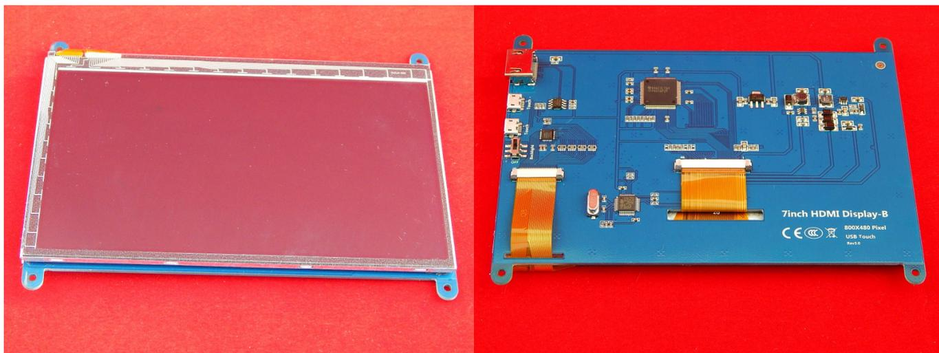
800x480 HDMI сенсорный LCD дисплей 7 дюймов экран Raspberry Pi3
