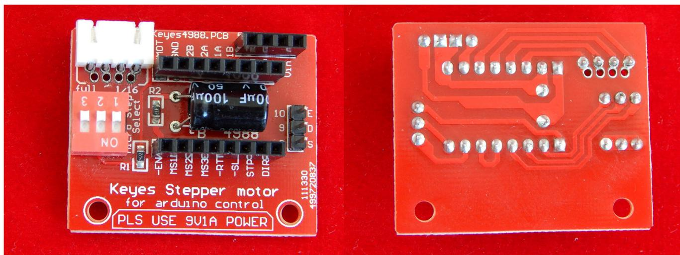
Адаптер позволяет подключить драйвера A4988/DRV8825 к шаговым двигателям без необходимости пайки и дополнительных конструкций.
