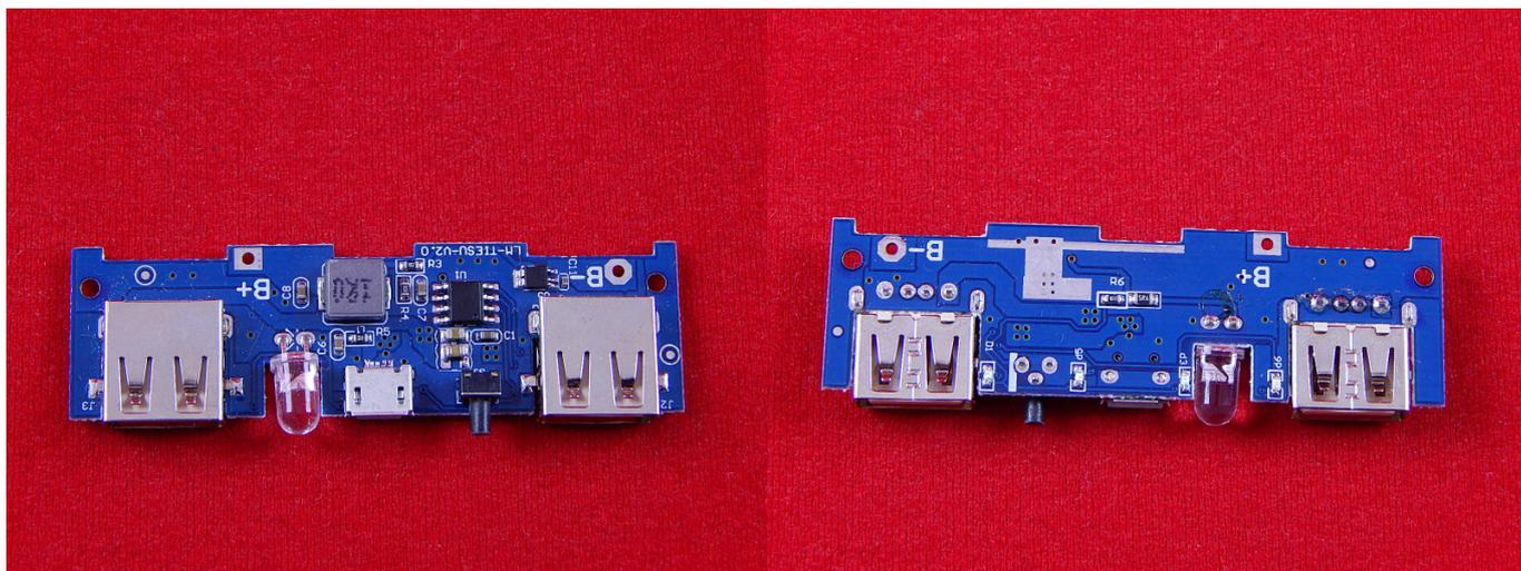
Плата к Power Bank на 1-2-3-4-5-6 аккумулятора, который способен заряжать устройства с силой тока в 5V 2A. Если подключить 2 устройства одновременно, то ток распределится равномерно на 2 устройства. Аккумуляторы соединять параллельно.
