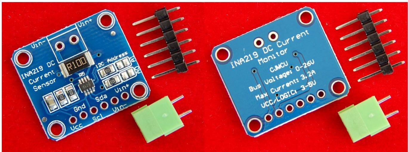
CJMCU-219 используется для измерения таких параметров постоянного тока как напряжение, ток и потребляемая мощность. Модуль выполнен на микросхеме INA219 – измерителем тока и напряжения с нулевым дрейфом и обладает малыми размерами и весом при очень больших возможностях и высокой точности измерений. Для увеличения точности в чипе INA219 предусмотрен регистр калибровки.
