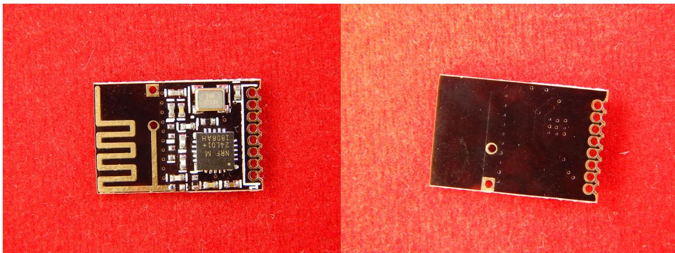
Модуль приемопередатчик NRF24L01+ 2.4GHz шаг 1.27, радиомодуль для связи микроконтроллеров между собой.
