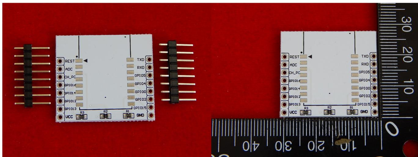
ESP8266 плата-переходник для ESP-07 ESP-08 ESP-12
