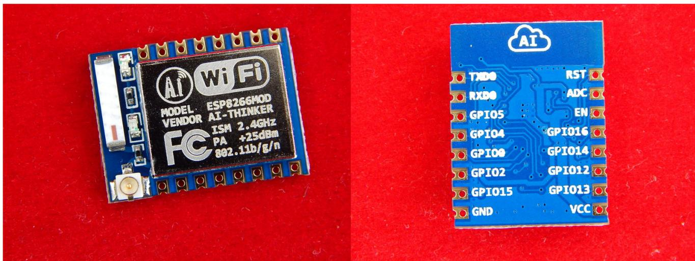
Миниатюрные WiFi модули ESP8266 довольно привлекательны для систем умного дома и домашней автоматизации.
