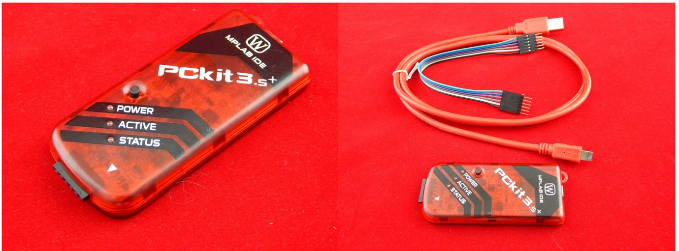
PICKIT 3 Программатор PIC контроллеров. Схемотехнический аналог программатора PICKIT 3 компании Microchip.
