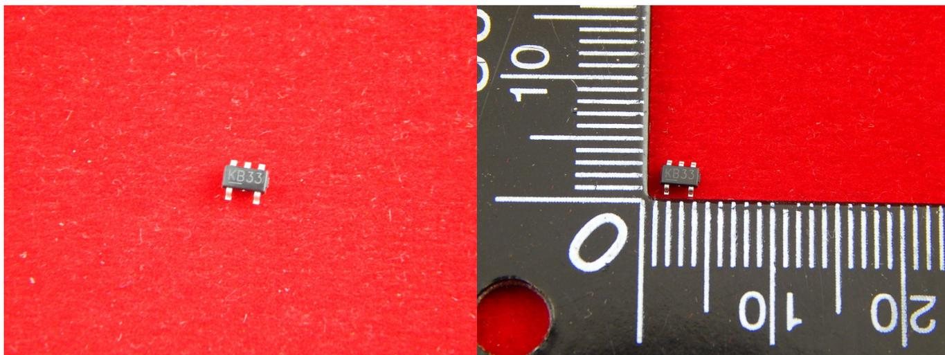
MIC5205-3.3YM5-TR - Фиксированный стабилизатор с малым падением напряжения, 2.5В до 16В, 165мВ, 3.3В, 150мА, SOT-23-5
