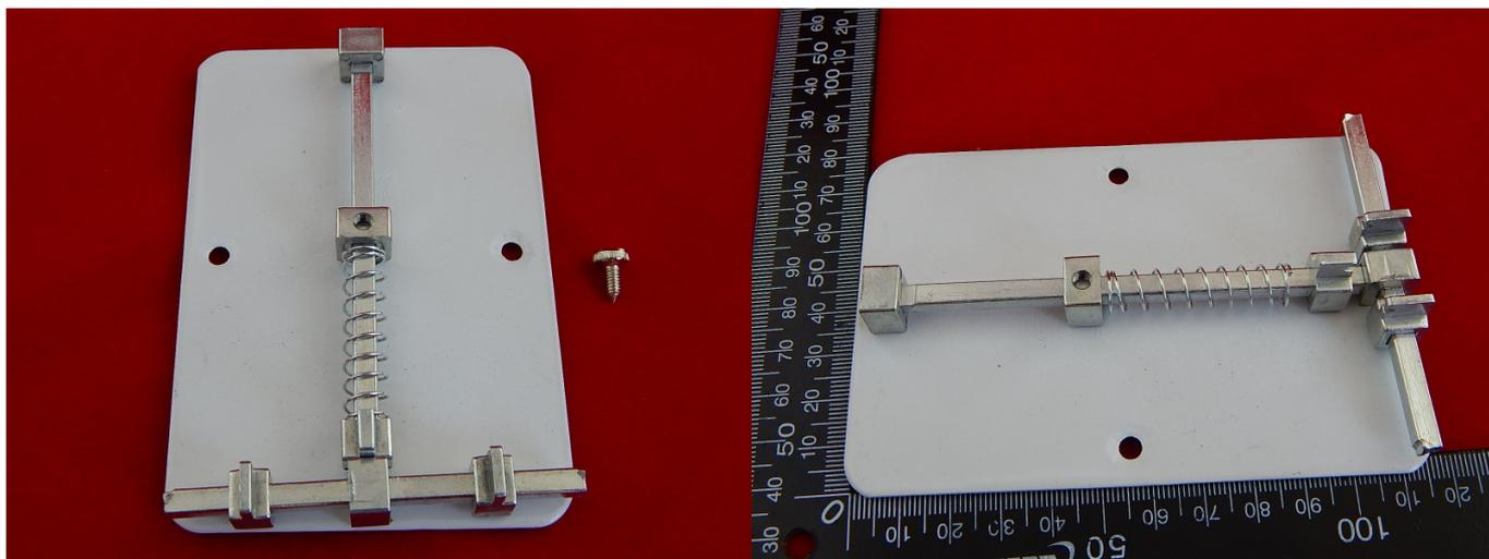
Удобный и компактный держатель печатных плат. Используется для фиксации печатной платы мобильного телефона во время пайки.
