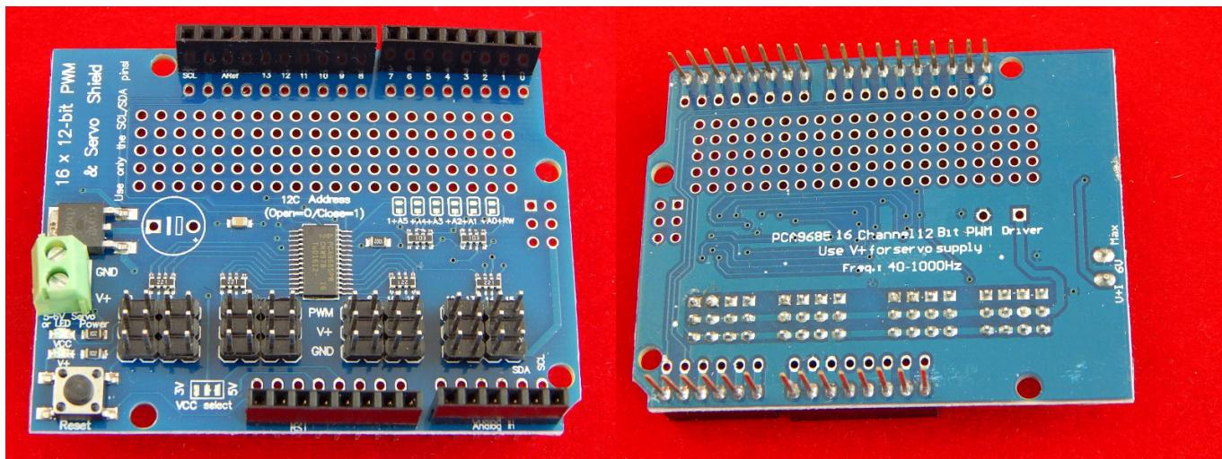
Плата расширения ШИМ-выходов Arduino для подключения большого количества сервоприводов и светодиодов.
