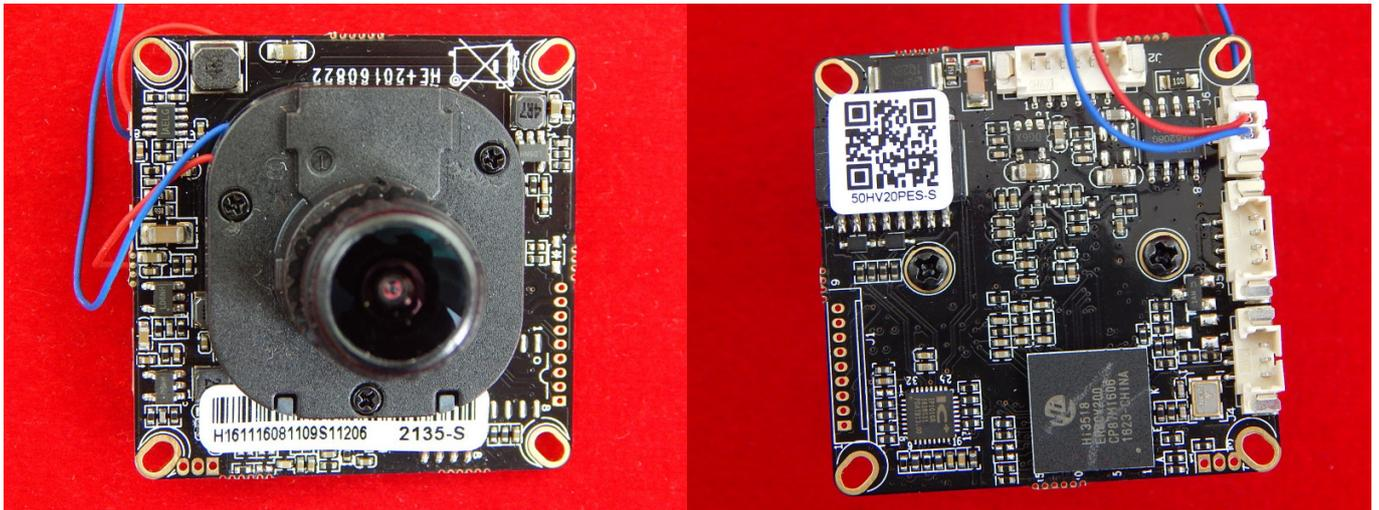
Двухъядерная 32-битная камера со встроенной операционной системой реального времени (RTOS). Цифровой процессор обработки сигналов(DSP)( Hi3518EV200 )
