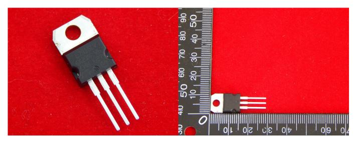
L7915CV (тонкая подложка), Стабилизатор напряжения -15B, 1.5A, 4%, TO-220
