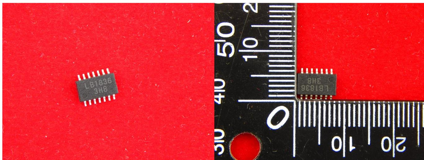
LB1836M двухканальные, двунаправленные драйверы щеточного двигателя с низким падением напряжения для использования в низковольтных применениях.
