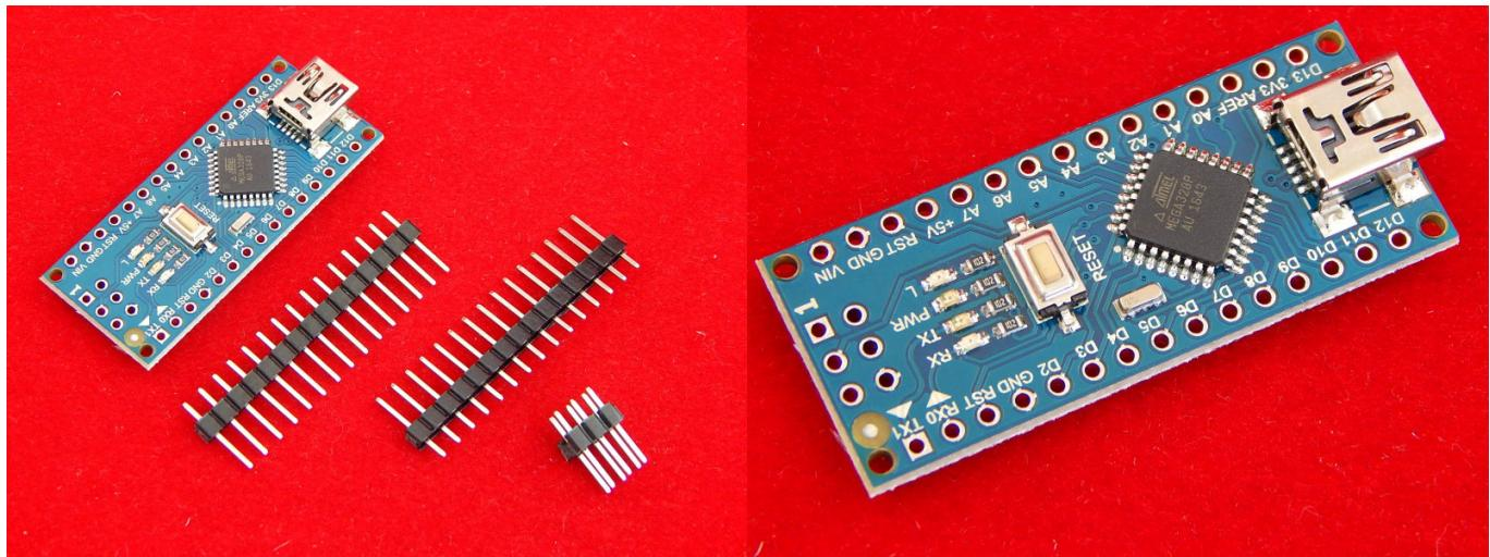
Платформа Nano, построенная на микроконтроллере ATmega328 и CH340G в качестве USB - RS232. Имеет небольшие размеры и может использоваться в лабораторных работах. Она имеет схожую с Duemillanove функциональность, однако отличается сборкой. Отличие заключается в отсутствии силового разъема постоянного тока и работе через кабель Mini-B USB.
