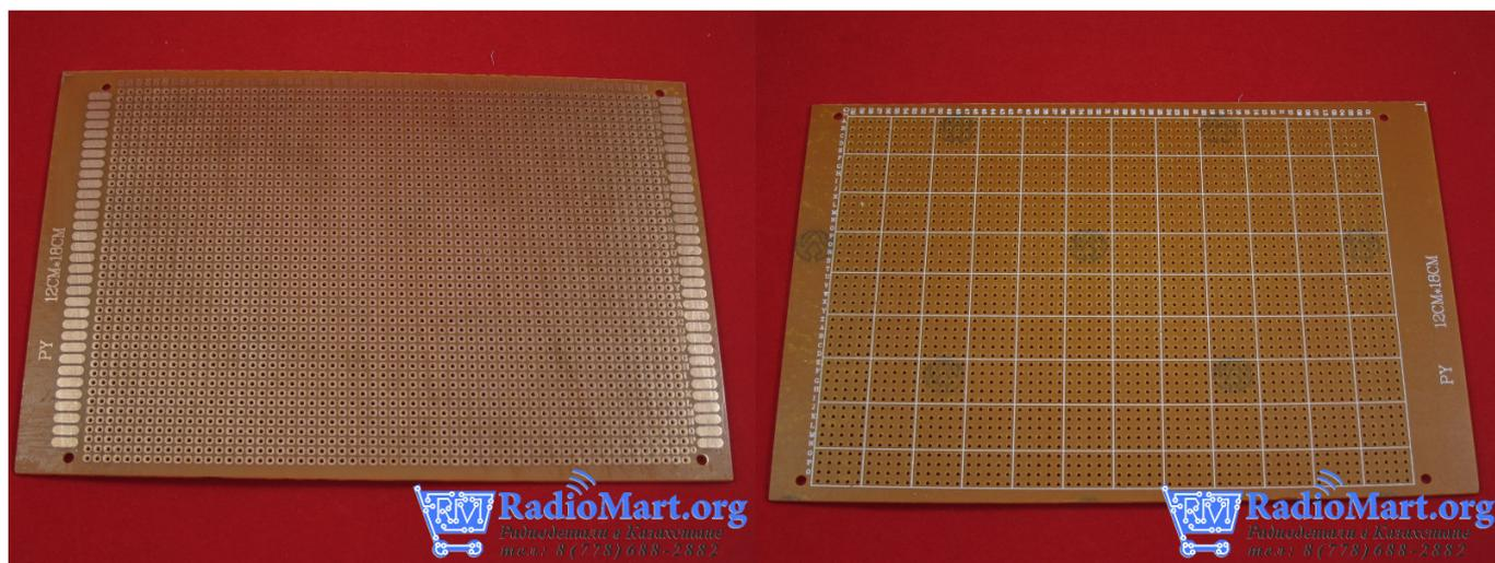
Плата для монтажа схем и конструкций
