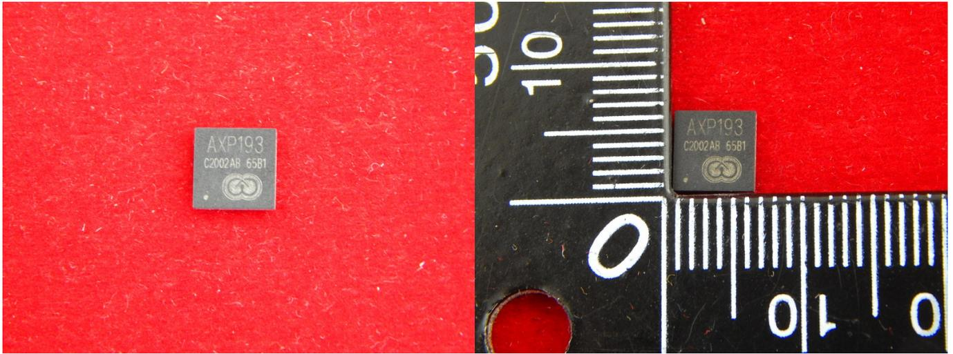
АХР 193 контроллер заряда батареи в корпусе QFN
