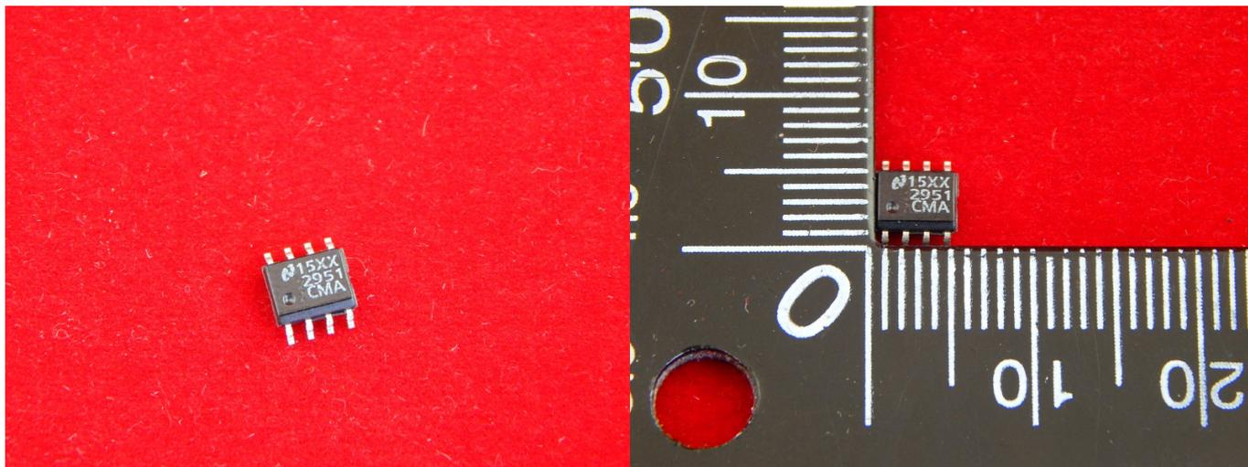
LP2951CM, Микромощный стабилизатор напряжения с программируемым выходом 1.24В...29В,
