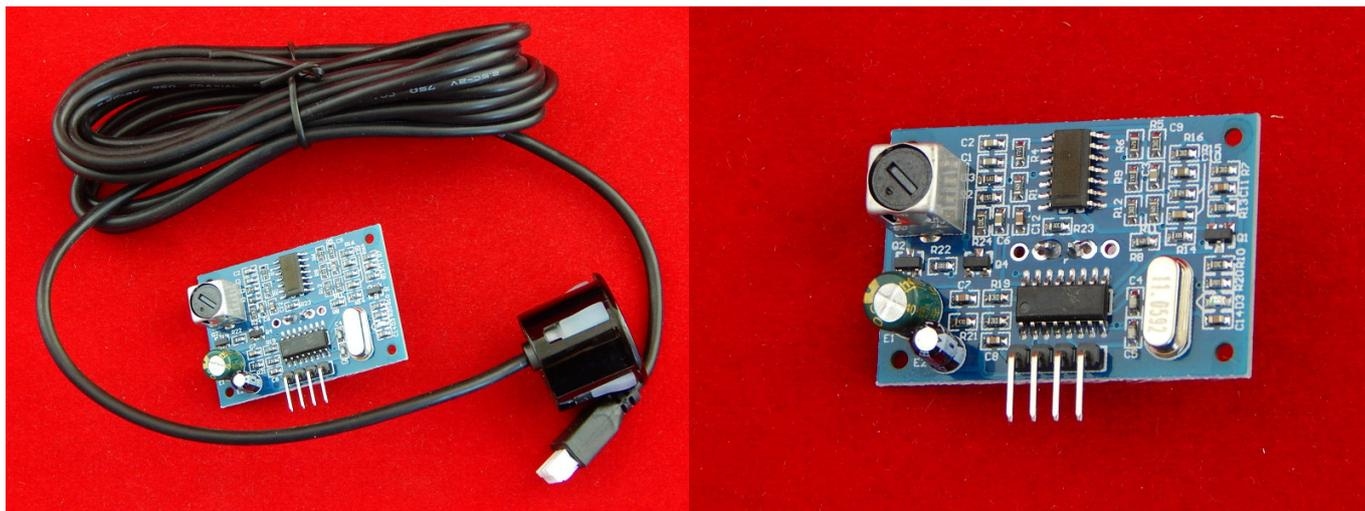
Водонепроницаемый ультразвуковой дальномер (датчик расстояния) JSN-SR04T. Генерирует звуковые импульсы и по отраженному сигналу определяет расстояние до объекта. Программно сравнивая показания датчика, можем определить, перемещается ли объект, скорость и направление движения.
